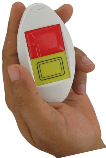
Das im Lieferumfang enthaltene leicht trennbare Umhängeband sorgt dafür, dass der Zweikanalsender immer am Körper getragen werden kann...
